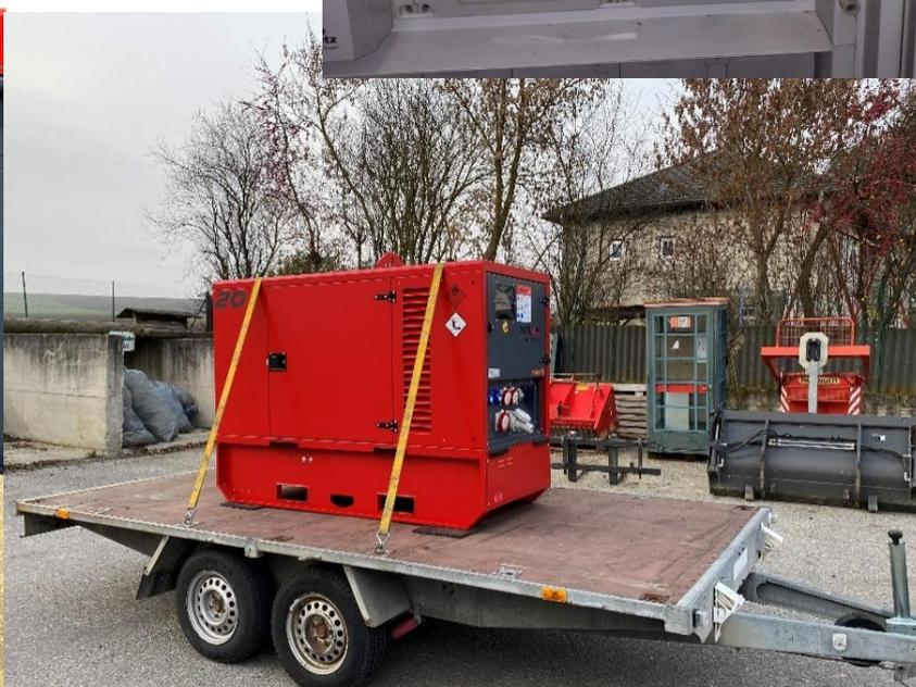
Die derzeit verfügbaren Notstromaggregate aller Freiwilligen Feuerwehren haben Leistungsgrößen von 4 bis 150 KVA, um eine gewisse Autarkie zu sichern. Der Aufbau eines vielseitigen Notstromaggregates auf einem Anhänger erweitert die Anwendungsmöglichkeiten enorm.
